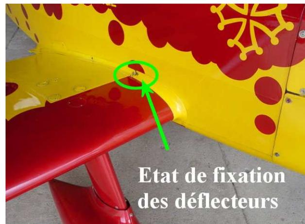
On vérifie l'état de surface du marche pied, et on inspecte la jambe de train pour détecter tout desserrage de vis (Spécial blondes et belges : la photo c'est la jambe droite)
