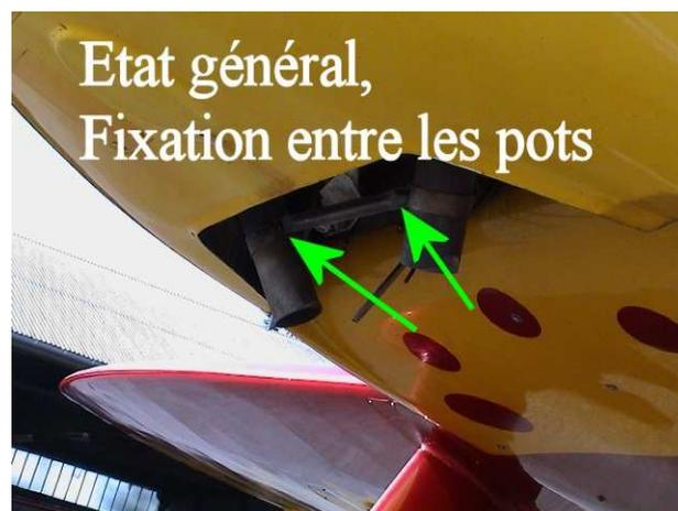
On vérifie donc ensuite le coté droit de l'avion (non je n'ai pas mis les photos de l'aile gauche ...) suivant le même procédé. On examinera l'état de surface du flanc de fuselage ainsi que la propreté de la prise statique.
